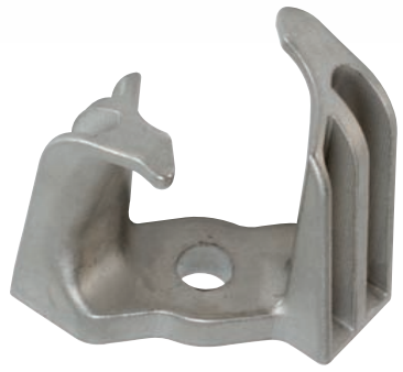
5 Cod. 8000 0208 Ancoraggio intermedio in acciaio inox; installato ogni 15 m, questo sistema permette il passaggio del connettore, senza sganci dell'operatore dalla linea di vita.
