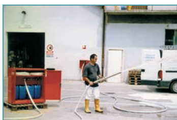
UNIFOAM MIX 45 CON LANCIA SCHIUMA BASSA ESPANSIONE UNI 45
